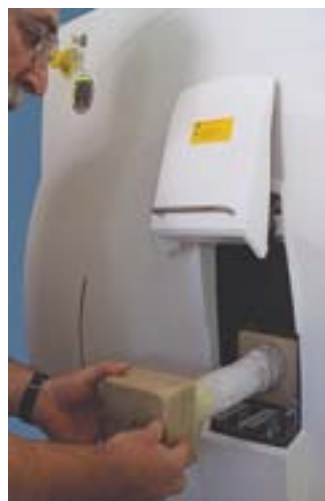
Der Knochen wird im Gerät eingespannt, sodass die Knochendichte gemessen werden kann.
