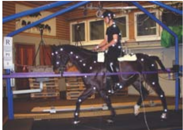
Pferd auf dem Laufband: Die Knochenvorsprünge am Pferd und am Reiter wurden mit Markern gekennzeichnet. Zur gleichen Zeit werden eine Ganganalyse (Ground reaction force) des Pferdes auf dem Laufband, sowie eine kinematische Messung (Bewegungsablauf) und eine Sattelmessung durchgeführt.
