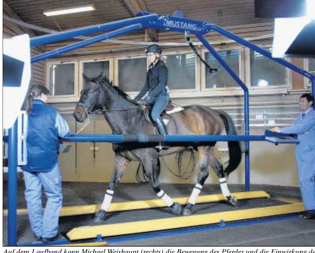
Auf dem Laufband kann Michael Weishaupt (rechts) die Bewegung des Pferdes und die Einwirkung der Reiterin punktgenau messen.
